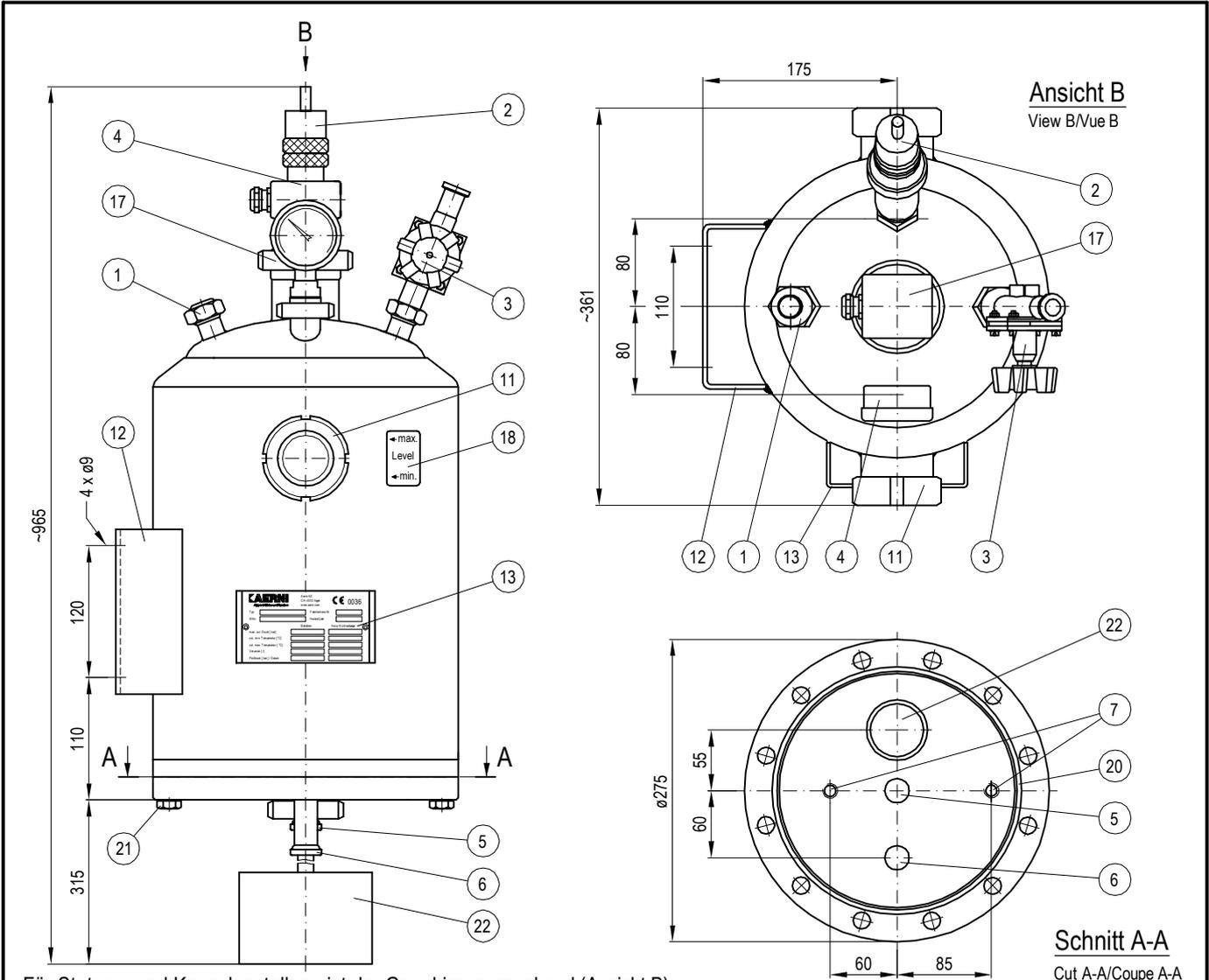
Für Stützen- und Konsolenstellung ist der Grundriss massgebend (Ansicht B)
