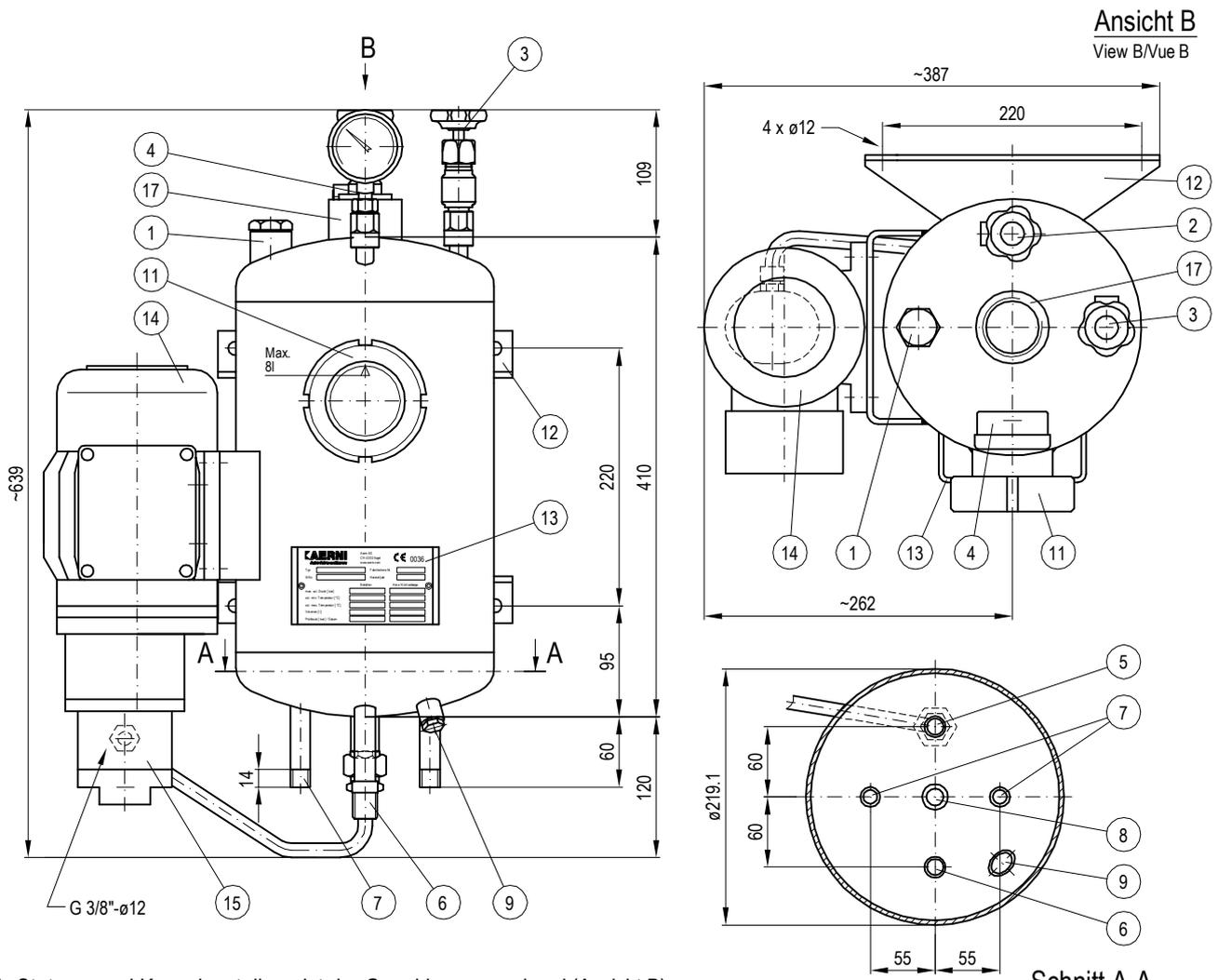
Für Stutzen- und Konsolenstellung ist der Grundriss massgebend (Ansicht B)
